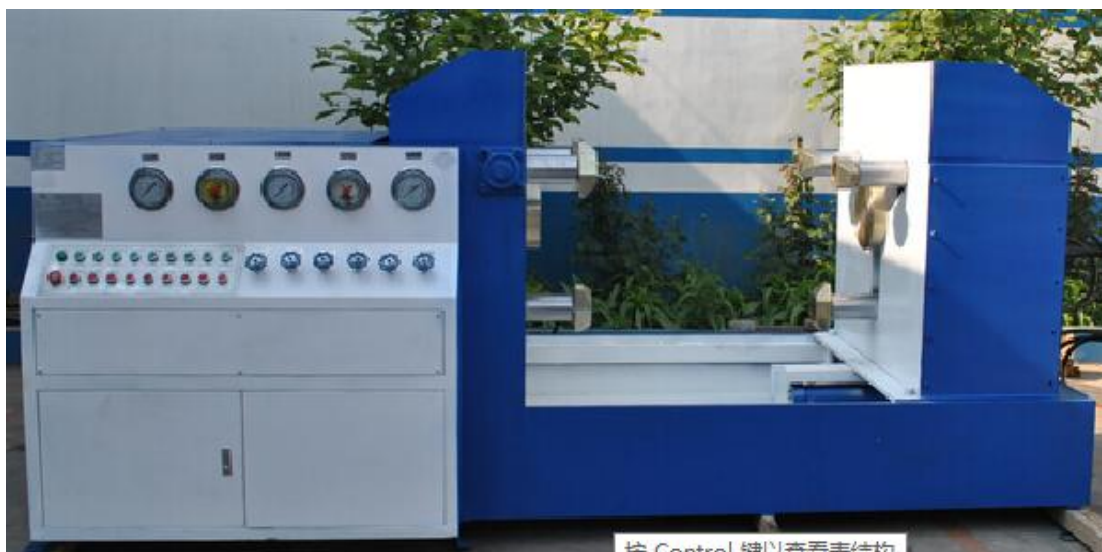
大口径阀门试压机，适用于口径范围 DN100 到 DN300 焊接阀门试压
